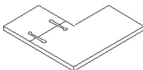
Eckverbindung mit Nut und Feder
